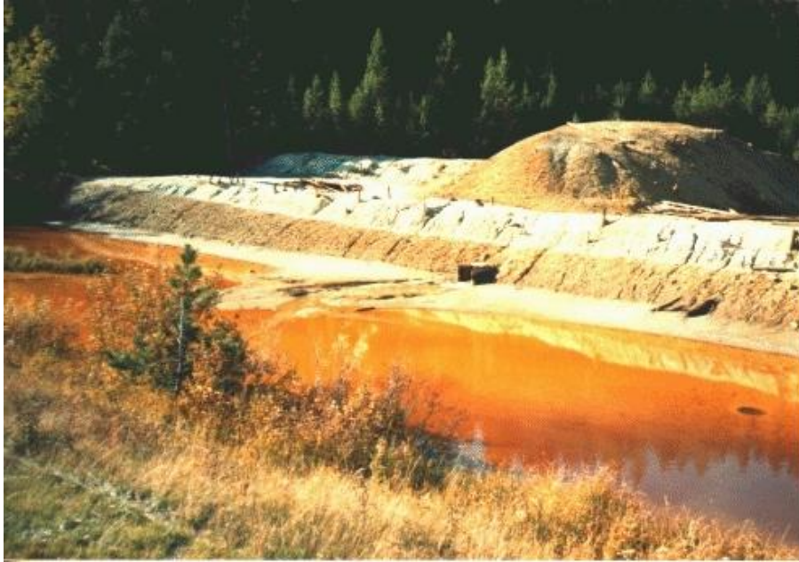
Drenaje ácido en el complejo minero Upper Blackfoot (Montana): www.deq.state.mt.us/Rem/Accomplishments/cecrubmc.asp
