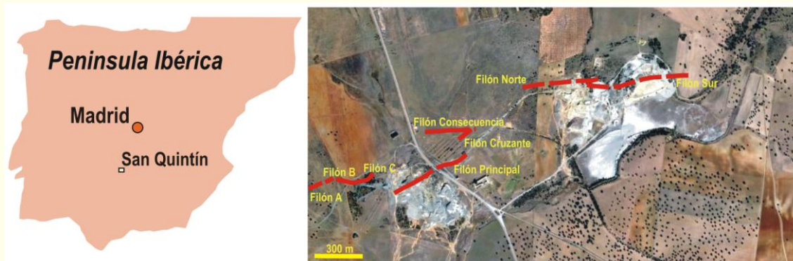
El campo filoniano San Quintín: localización (izquierda) proyección en superficie (rojo) de los principales filones del grupo (derecha). En gris en la imagen: balsas y escombreras abandonadas de distintos periodos de actividad minera
