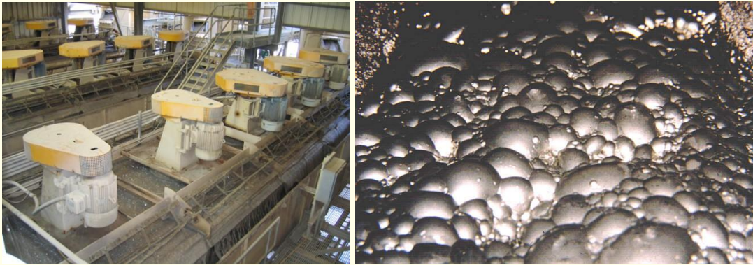
Celdas de flotación en una planta de concentración de sulfuros y la espuma que contiene la fase sulfurada que se quiere concentrar. http://www.fipr.state.fl.us/Education2004/11-4.JPG y http://web.uct.ac.za/depts/geolsci/dlr/hons/u42a.jpg
