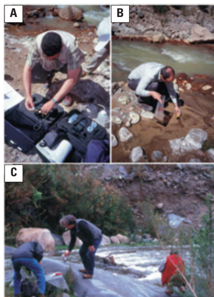
Figura 2. Trabajos de campo en las cuencas hidrográficas. A: Sistema portátil para la medición de oxígeno disuelto en las aguas de río y pH. B y C: Toma de muestras en las cuencas de los ríos Elqui y Limarí (respectivamente).
