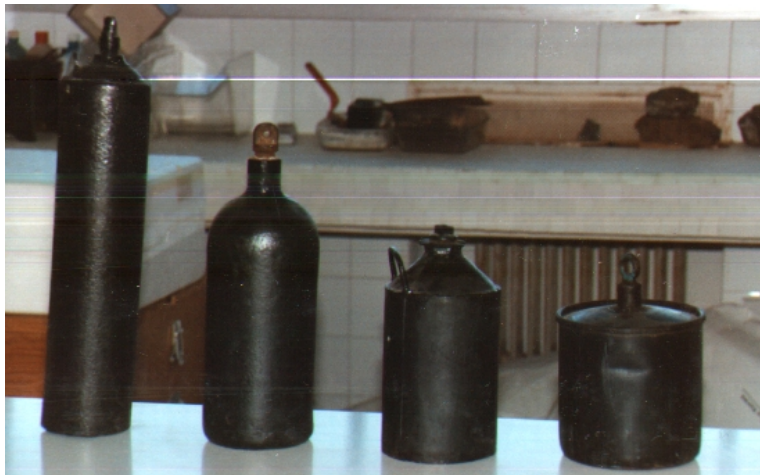
Figura 9.- Distintos modelos de frascos, unidad internacional de comercialización del mercurio (34,5 kg Hg).
