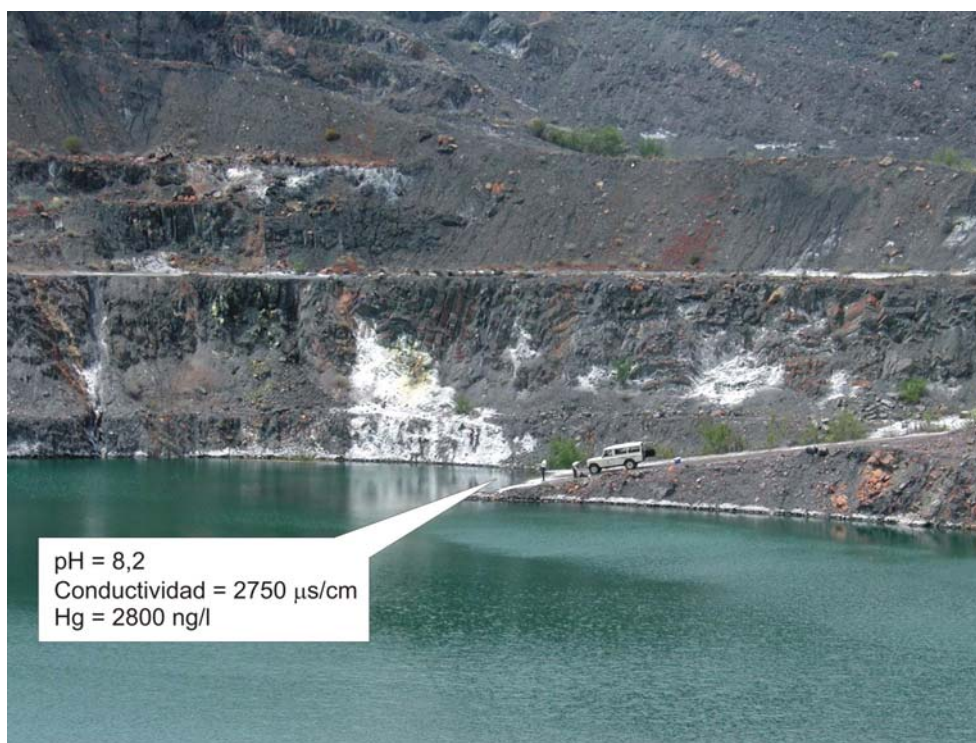
Figura 13.- Embalse de fondo de corta de El Entredicho (julio de 2003). Se indican algunos parámetros medidos en el mismo.
