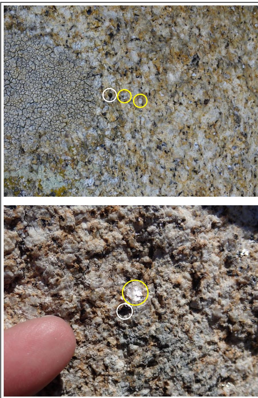
Arriba, granito de dos micas de Lindoso, el liquen mide unos 3 cm. Abajo, Granito de Soajo. Círculos amarillos: muscovita; círculos blancos: biotita.
