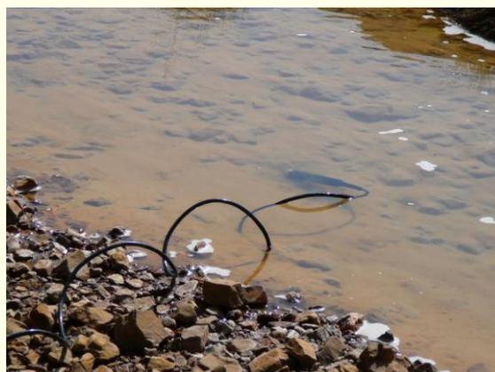
La sonda multiparamétrica YSI 556MPS® (EUP – Almadén, UCLM) mide: oxígeno disuelto (% saturación; mg/L), temperatura, conductividad (mS/cm), salinidad (ppt), pH, ORP (*oxidation reduction potential*) (mV), TDS (*total dissolved solids*) (g/L) y resistividad (KOhm x cm).
