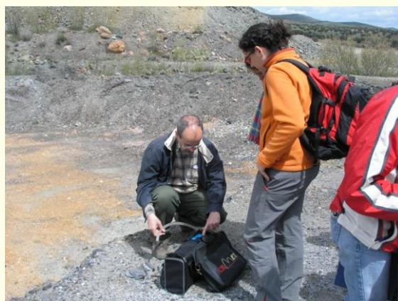
El Lumex RA-915+® (EUP – Almadén, UCLM) es un espectrómetro portátil diseñado para el análisis de mercurio en aire, aguas, suelos y plantas. Los límites de detección para mercurio son muy bajos:  $0.5 \text{ ng/m}^3$  en aire,  $0.5 \text{ } \mu\text{g kg}^{-1}$  en suelos y  $2 \text{ } \mu\text{g kg}^{-1}$  en plantas.
