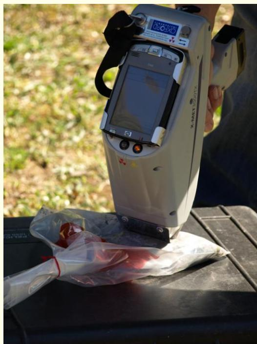
El análisis geoquímico de suelos y sedimentos (elemento – ppm) se realiza mediante el uso de un equipo OXFORD XMET3000-TX® (EUP – Almadén, UCLM), utilizando un programa de calibración para muestras con matriz similar, y asegurando la calidad de los análisis mediante muestras duplicadas y materiales de referencia certificados.
