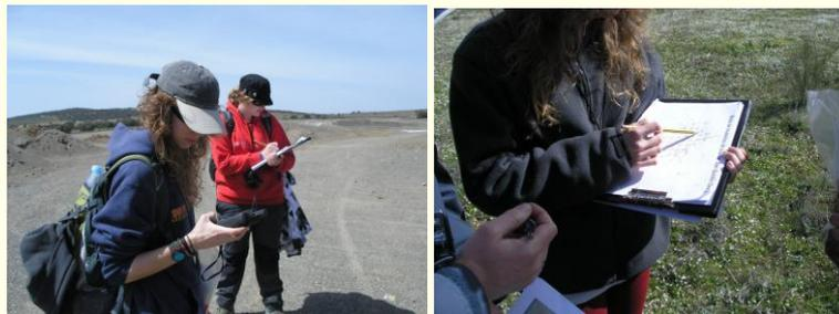
*Posicionamiento en el campo mediante GPS y localización mediante MapSource®. Los GPSs son cargados con la base TOPO España®, a la escala 1: 25.000.*
