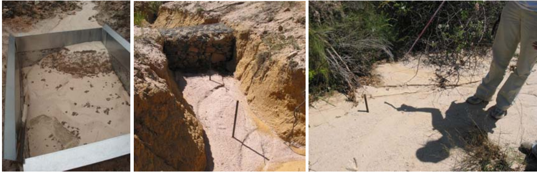
Figura 3. A) Trampa de sedimentos construida con chapa galvanizada (El Arenal, Segovia). B) Gavión construido en un canal de incisión, que actúa como trampa de sedimentación (Alameda, Segovia). C) Varilla situada en el fondo de un canal arenoso en Ituero y Lama; en el caso que muestra la imagen, la varilla ha quedado enterrada varios centímetros con respecto a su posición original, tras un evento tormentoso; el espesor concreto de sedimentación queda registrado por una arandela, ahora enterrada, que marca la posición inicial del fondo del canal, y que es preciso desenterrar para conocer su posición.
